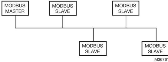
**Fig. 5. Allowed Modbus wiring topology.**
